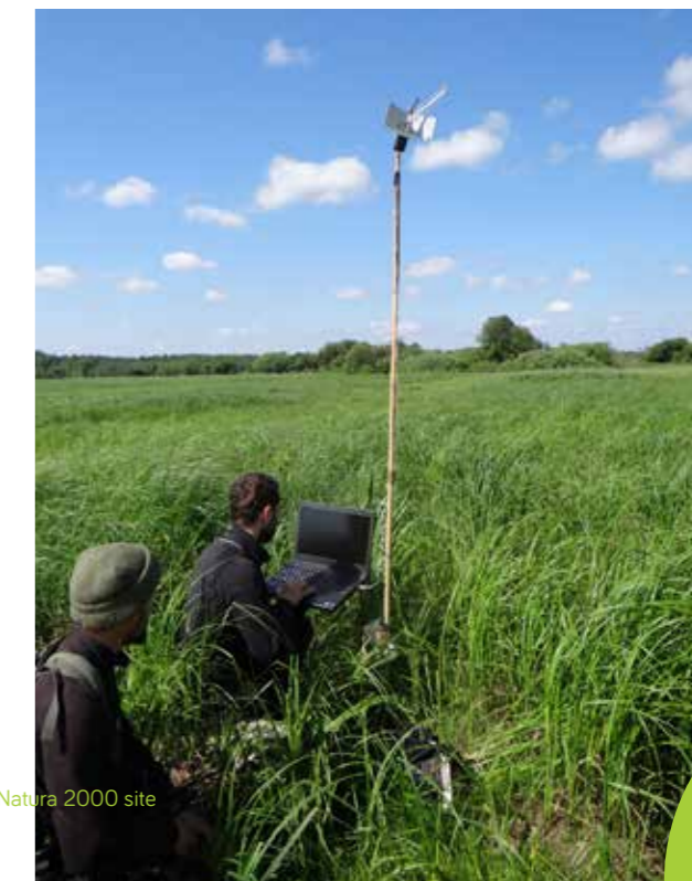
Szczytowanie danych z anteny odbiorczej/ Data downloading from the receiving antenna
