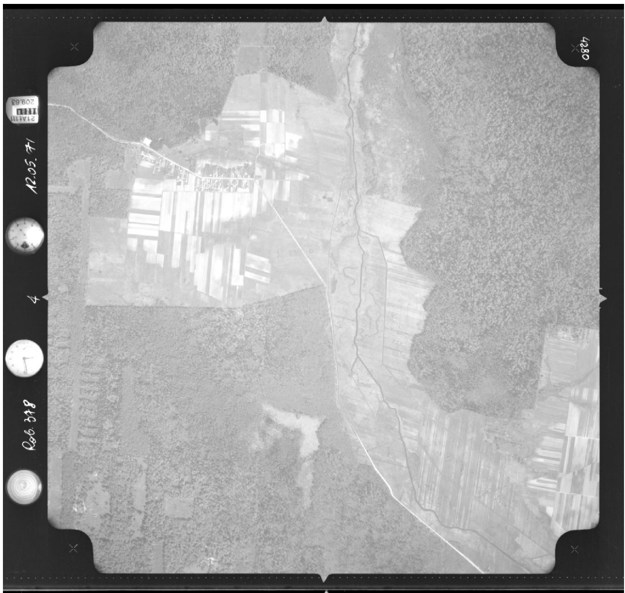
Rys. 2.5 Świeżo uregulowane (wyprostowane) koryto rz. Narewki pomiędzy Białowieżą a Budami z widocznymi, odciętymi meandrami oraz elementami doprowadzalników i rowów szczegółowych nowopowstałej sieci melioracyjnej (NW część mapy). Zdjęcie wykonano 12.05.1971 r. Źródło danych: CODGiK.
